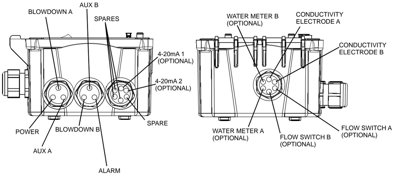
**Figure 3 Conduit/Wiring Configuration**
